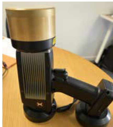
Afin d'atteindre une minéralisation de précision chez les ruminants, Animine a développé, en lien avec l'Ipem, AniGun, un outil portable destiné à analyser la fraction minérale des fourrages directement sur le terrain, basé sur la technologie XRF, spectrométrie par fluorescence des rayons X.
